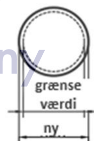
mejselbolt med runt tværsnit
